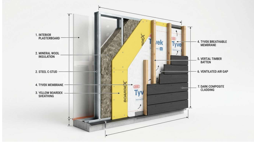
SFV Çok Katmanlı Dış Duvar & Akustik Sönümlleme Katmanları
