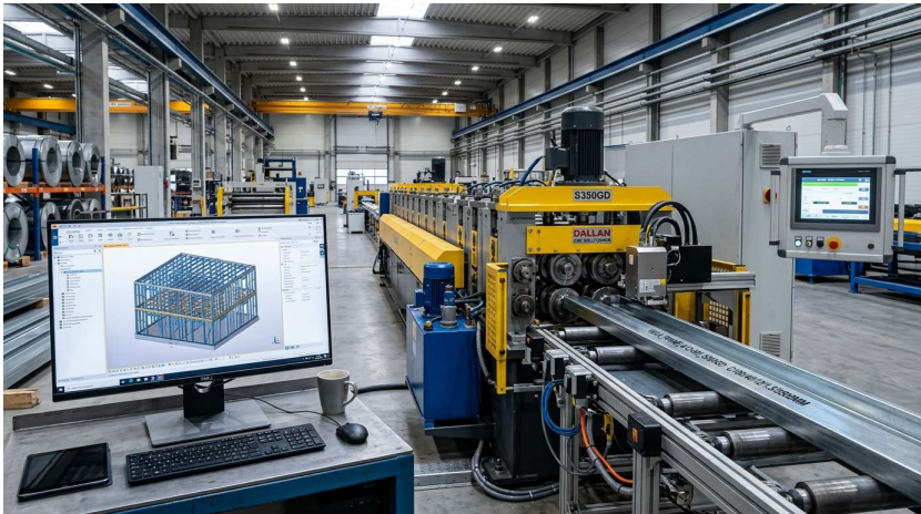
Automatisierte 8-Stationen-CNC-Rollformanlage (±1 mm Toleranz)
