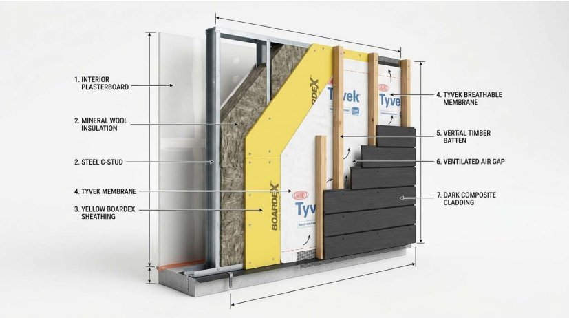
SFV Mehrschichtige Außenwand & Akustikentkopplung
